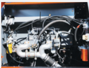
Сгруппированные в одном месте выносные фильтры и точки ежедневной проверки
